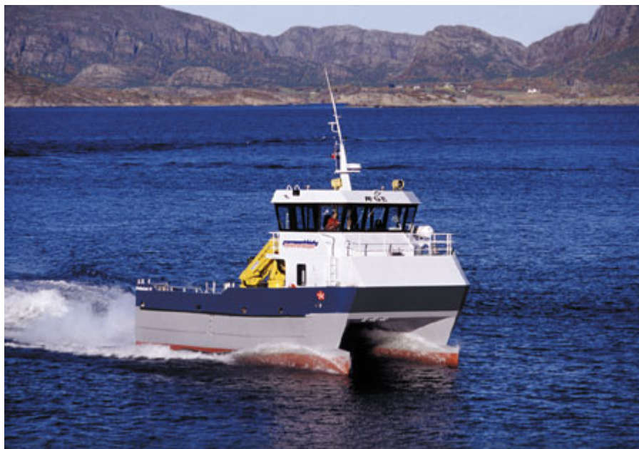
Figur 4. Servicebåten "Æge", en moderne service-/dykkerbåt med ROV ombord.
